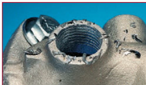
Сорванная резьба до ремонта
