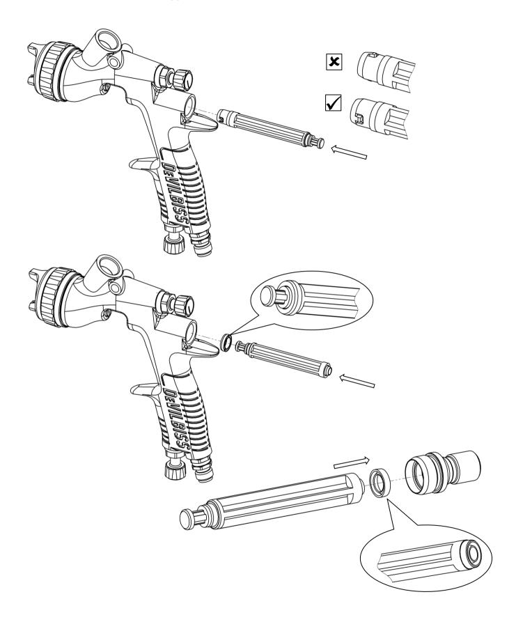
(12/24) РАЗБОРКА ВОЗДУШНОГО КЛАПАНА
